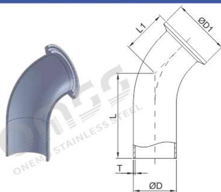
DT-4.1.1-5 45° CLAMP/WELD ELBOW (DT-13)
